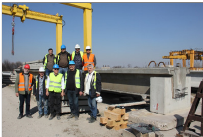
3. ábra: U gerenda próbaterhelése, Tokyo Rope szénszálalás pászmával feszítve (2023. 04. 27.)
